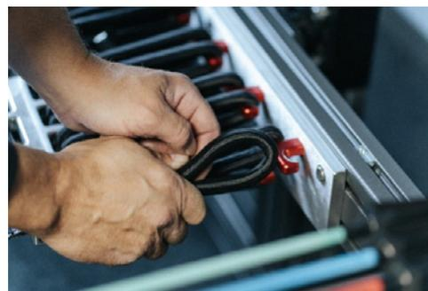
3. Dévissez les deux vis de la barre du côté des bungees à l'aide d'un tournevis hexagonal (taille 2).
