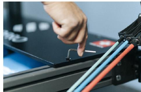
2. Dévissez la vis du capteur défectueux à l'aide d'un tournevis hexagonal (taille 2.5).
