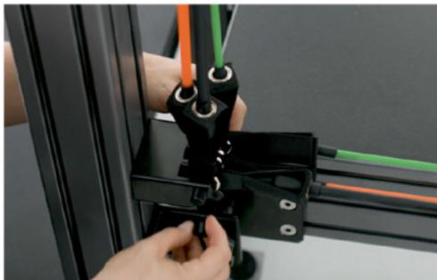
2. Retenez tous les Tubes et retirez délicatement les vis en plastique de la fixation. Relâchez les Tubes afin qu'ils ne soient plus sous tension.
