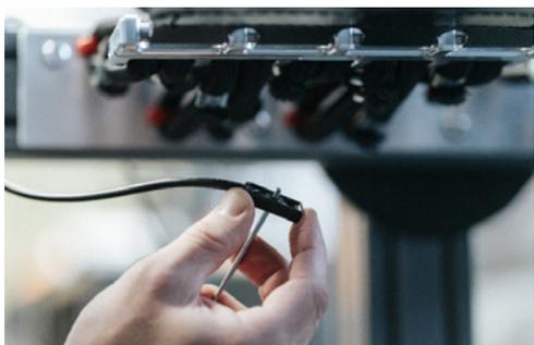
6. Fixez ensuite les câbles des capteurs à l'aide des fixations et des rails en plastique dans la rainure du cadre du swingboard.
