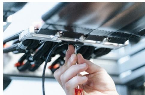
3. Détachez les fixations de câbles et les rails en plastique du cadre du swingboard, puis retirez délicatement le câble du capteur de la rainure.
