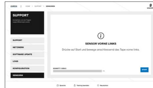
2. Maintenant, les tapes doivent être déplacés comme décrit, appuyez sur « Start ». Dès que la coche verte apparaît, le capteur a été détecté avec succès. En cas d'erreur, vous pouvez répéter l'étape de détection du capteur en cliquant sur « Réessayer ».
