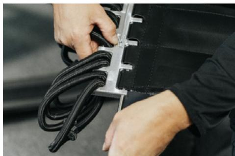
5. Prenez le nouveau tape et insérez ses boucles dans les encoches de la pièce métallique. Faites progressivement passer la barre à travers les boucles du tape pour le fixer.
