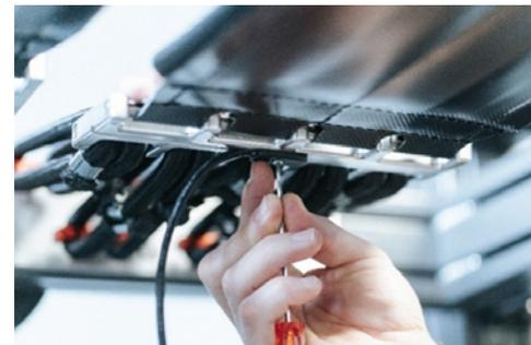
3. Lösen Sie die entsprechenden Kabelhalter und Plastikschienen vom Swingboardrahmen und ziehen Sie das entsprechende Sensorkabel vorsichtig aus der Nut.
