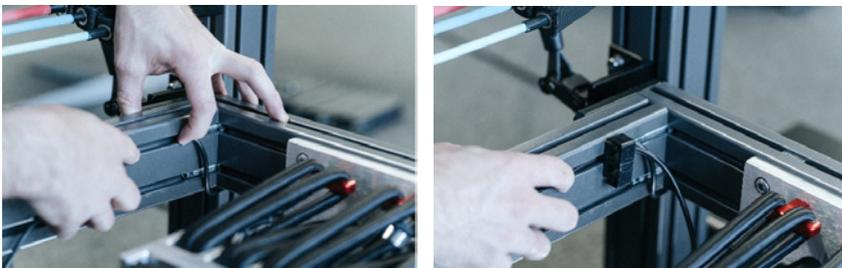
7. Stecken Sie das Sensorkabel in das Computer Modul.
