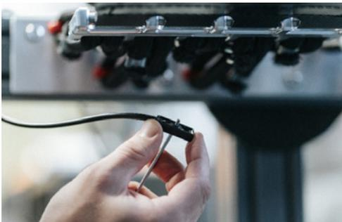
6. Fixieren Sie die Sensorkabel anschliessend mithilfe der Kabelhalter und Plastikschienen wieder in der Nut des Swingboardrahmens.
