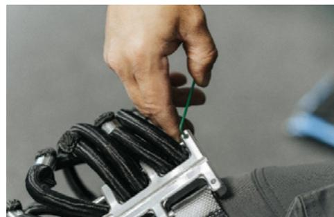
4. Stossen Sie den Stab aus der Tape-Halterung. Tauschen Sie entweder einzelne defekte Bungees oder alle Bungees gesammelt aus.
