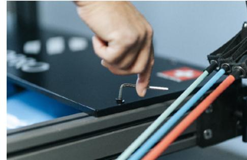
2. Lösen Sie die Schraube am defekten Sensor mit einem Sechskantschraubenzieher (Grösse 2.5).
