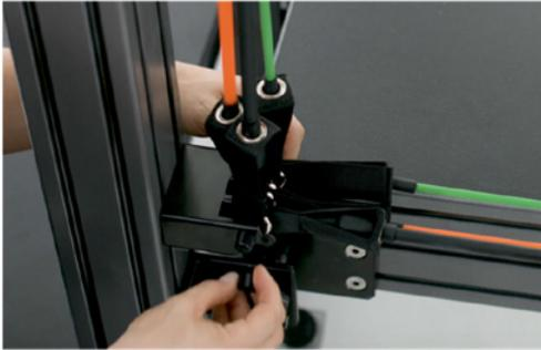
2. Halten Sie alle Tubes fest und ziehen Sie die Kunststoffschraube sorgfältig aus der Halterung. Bringen Sie die Tubes in einen ungespannten Zustand.
