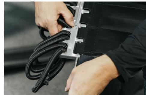
5. Nehmen Sie das neue Tape und bringen Sie die Schlaufen des Tapes in die Aussparungen des Metallteils. Stossen sie den Stab nach und nach durch die Schlaufen des Tapes, um dieses zu befestigen.
