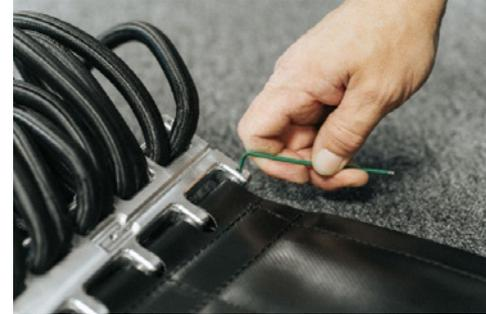
4. Stossen Sie den Stab aus dem Tape-Halterung und legen Sie das alte Tape beiseite.
