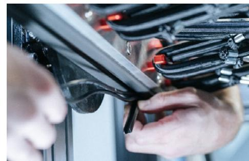
4. Verfolgen Sie das entsprechende Sensorkabel bis zum Computermodul und stecken Sie das Sensorkabel dann aus.
