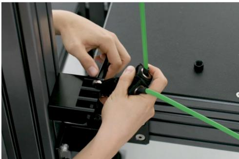
4. Resserrez fermement la vis en plastique et l'écrou à la main.
