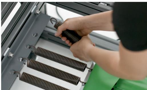
3. Accrochez le nouveau ressort tout d'abord sur le côté intérieur, puis sur le côté extérieur du Swingboard. Remplacez la gaine de protection autour des ressorts, fermeture velcro regardant vers le bas.
