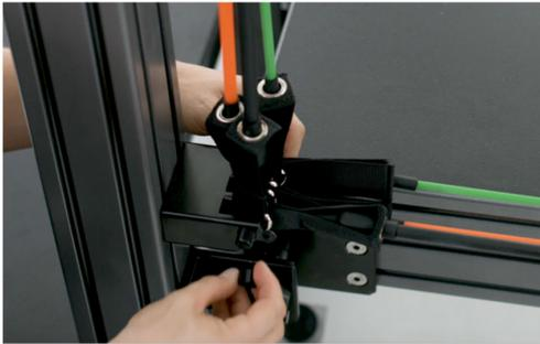
2. Tenez fermement tous les Tubes et retirez délicatement la vis en plastique de sa fixation. Détendez les Tubes.
